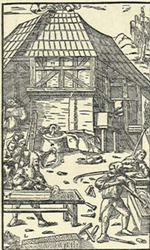
Schachtofen und Gießen von Ballenzinn.
